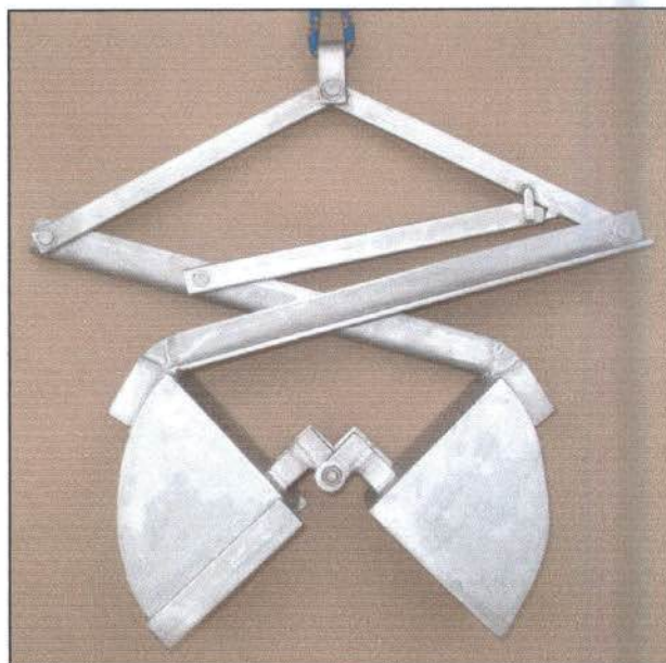
Figura 12. Amostrador do tipo van Veen , com área amostras de 0,022 m 2 .
