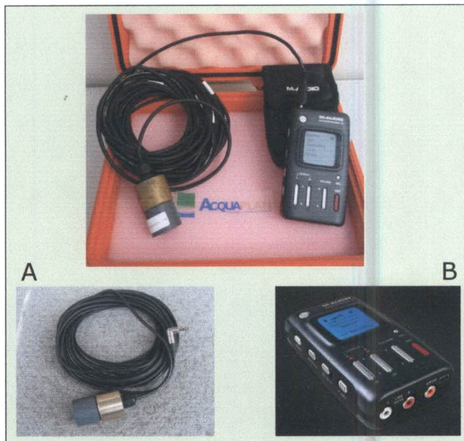
Figura 18. (A) Hidrofone Cetacean Research SQ26-08 e (B) gravador digital M-Audio Microtrack II.
