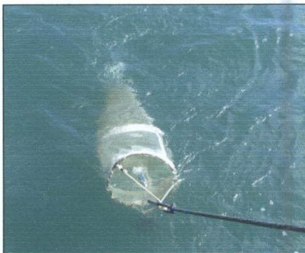
Figura 5. Rede de plâncton com malha de 220 \mu\text{m} de abertura.
