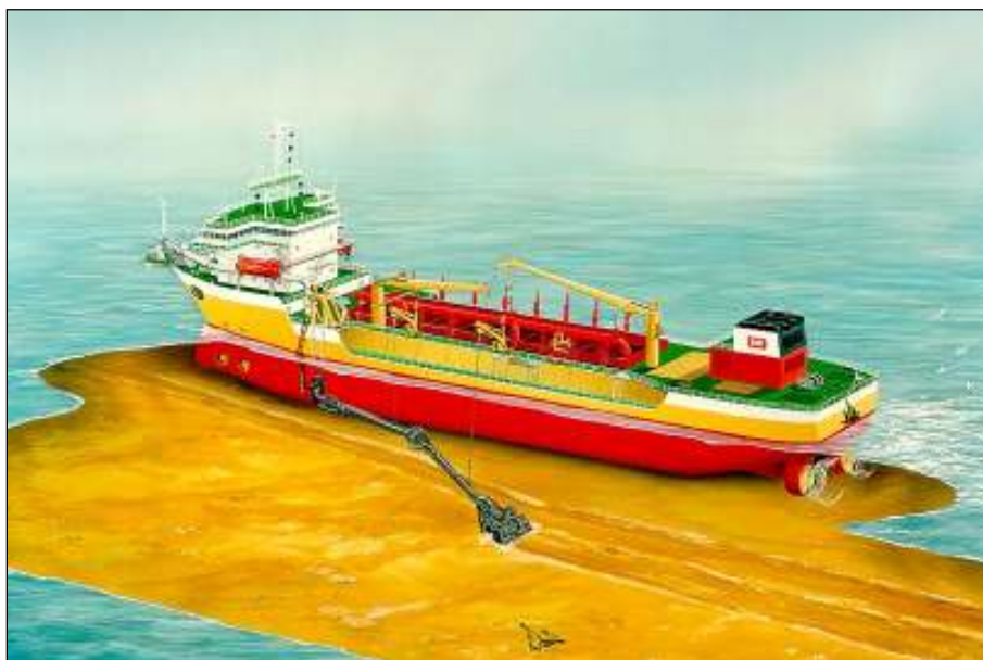
Figura 75. Ilustração de um equipamento de dragagem autotransportadora do tipo hopper em operação.
