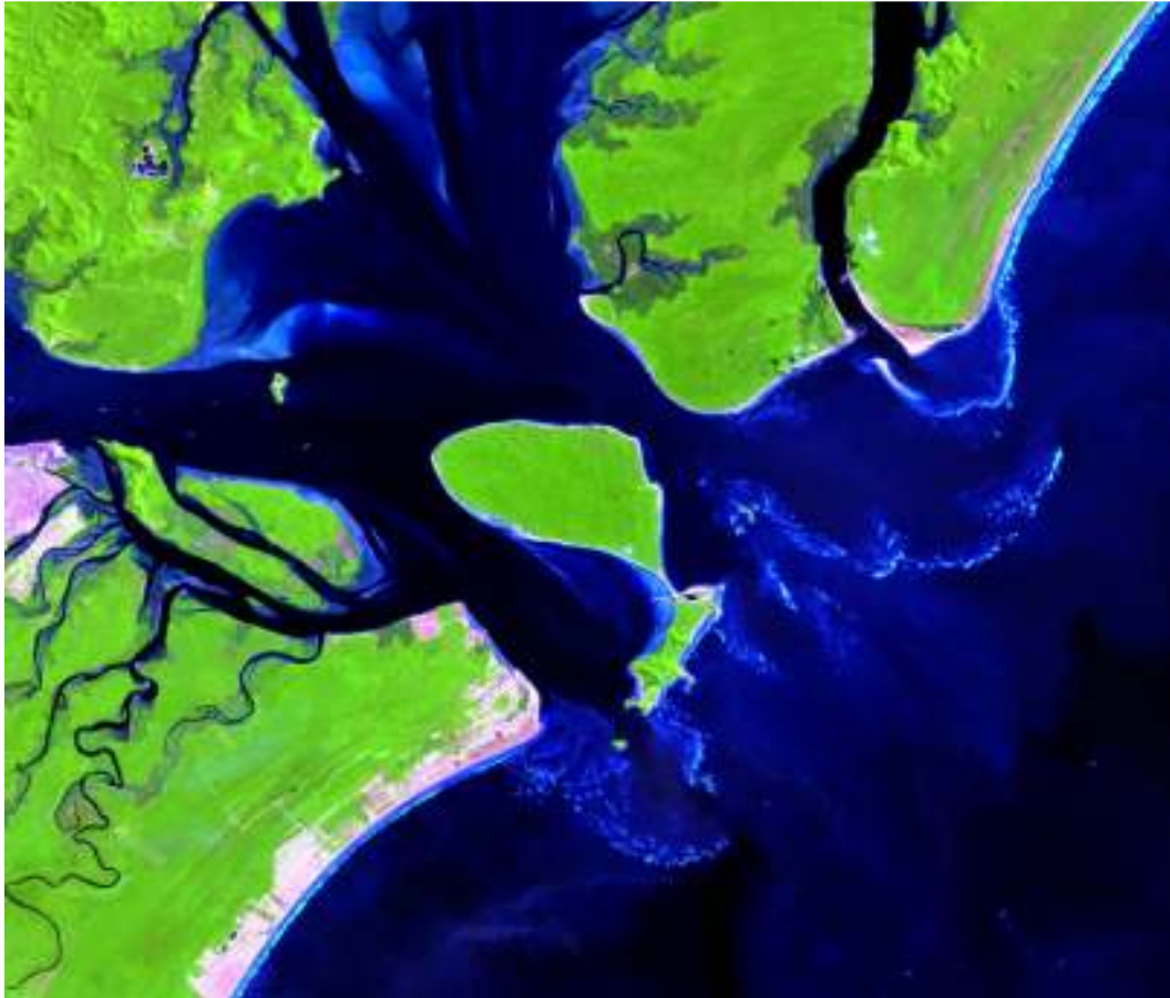
Figura 299. Imagem de satélite LANDSAT 5 de 1999, onde se observam bancos e zonas de arrebentação correspondentes aos deltas de maré vazante associados às desembocaduras da baía de Paranaguá e Canal do Superagüi. Fonte: Ângulo et al. (2006b).
