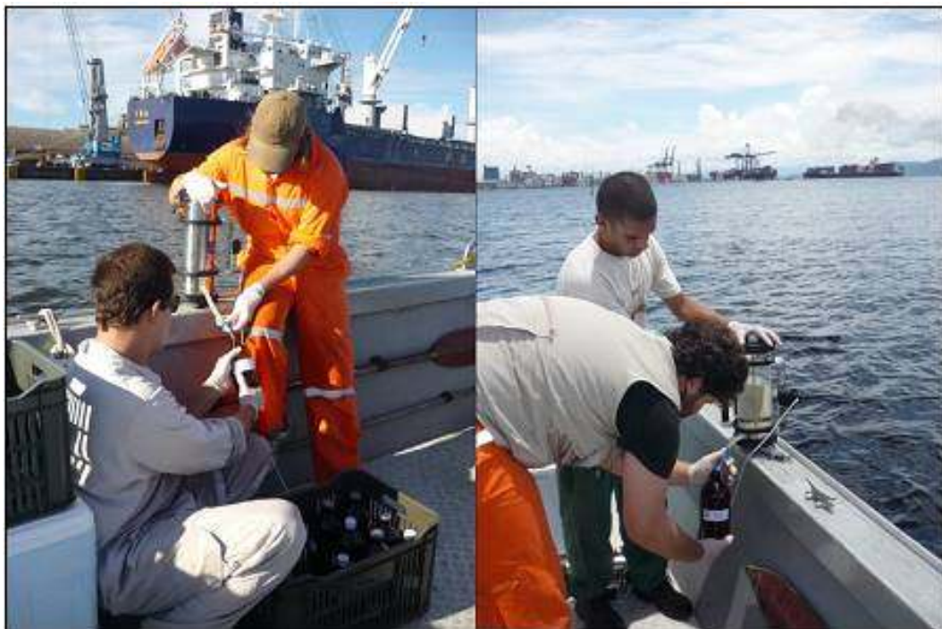
Figura 78. Coleta das amostras de água com a utilização das garrafas tipo van Dorn .
