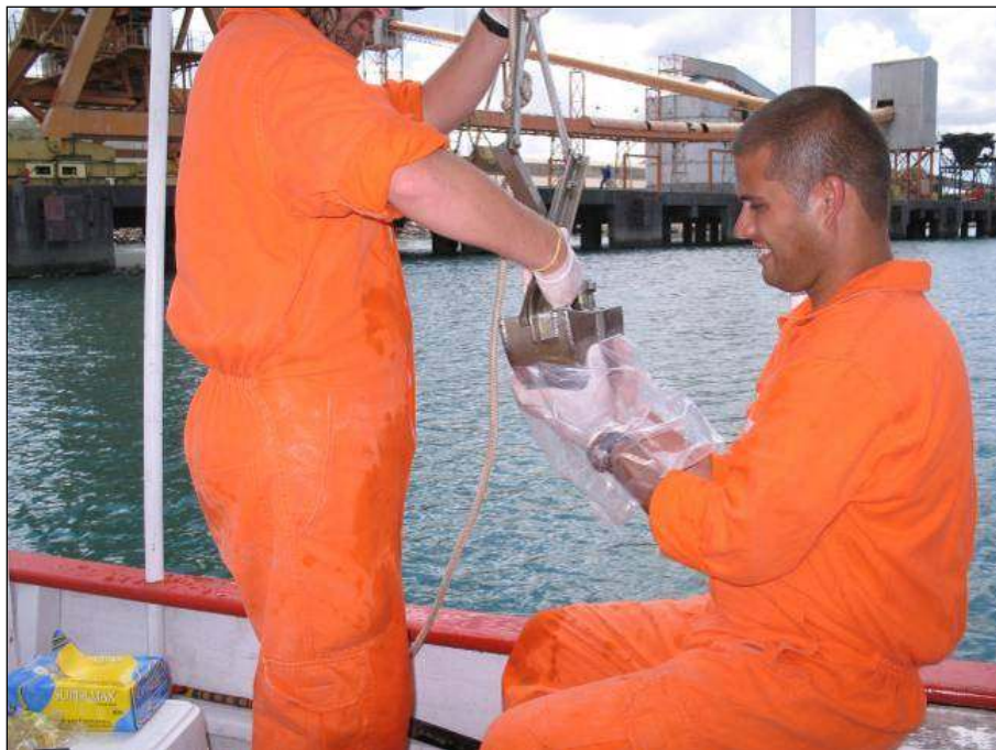
Figura 319. Utilização de draga tipo van Veen para coleta de amostras de sedimento. Na imagem, recolhimento da amostra para para a caracterização da comunidade bêntica.
