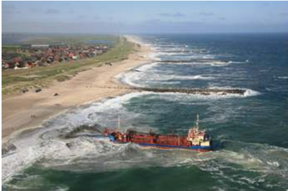
Figura 632. Ilustração de equipamento de dragagem com cisterna e sistema de bombeamento, operando na alimentação artificial de praia na costa oeste dinamarquesa.
