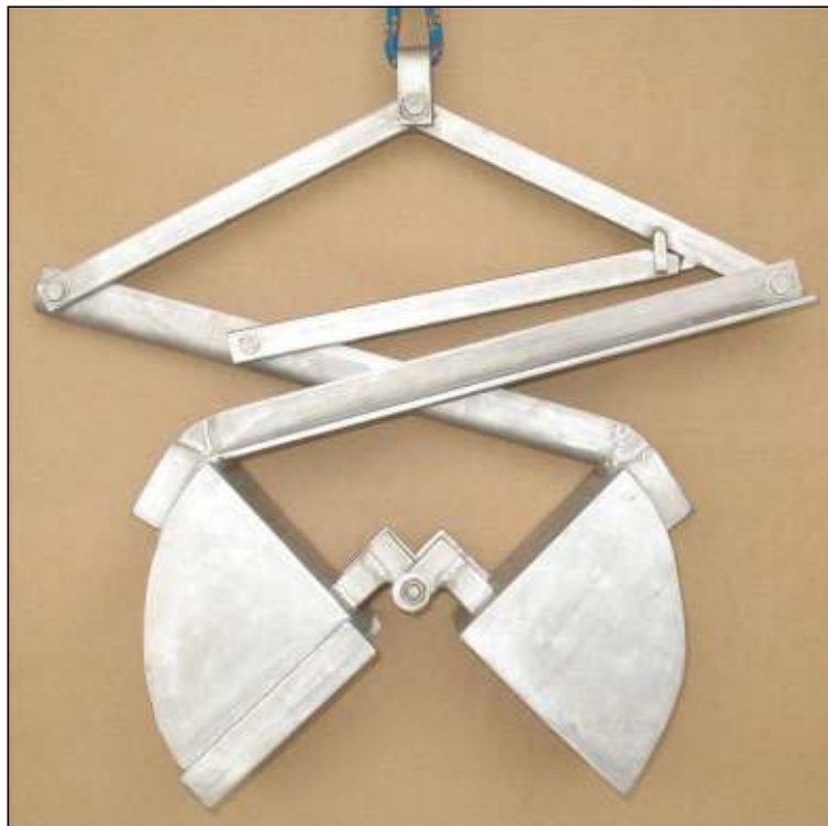
Figura 85. Amostrador do tipo van Veen utilizado na coleta de sedimento superficial.
