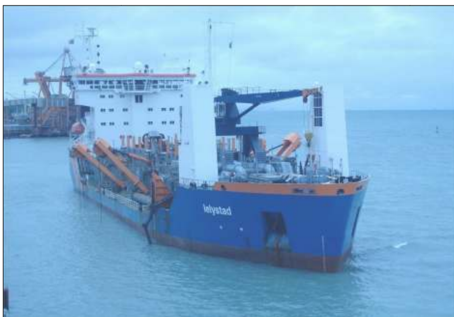
Figura 61. Exemplo de draga autotransportadora com capacidade de armazenamento em cisterna de 10.000m 3 .
