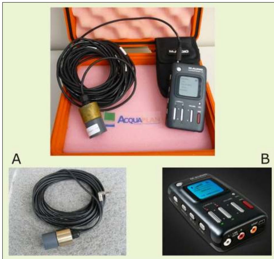
Figura 329. (A) Hidrofone Cetacean Research SQ26-08 e (B) gravador digital M-Audio Microtrack II .
