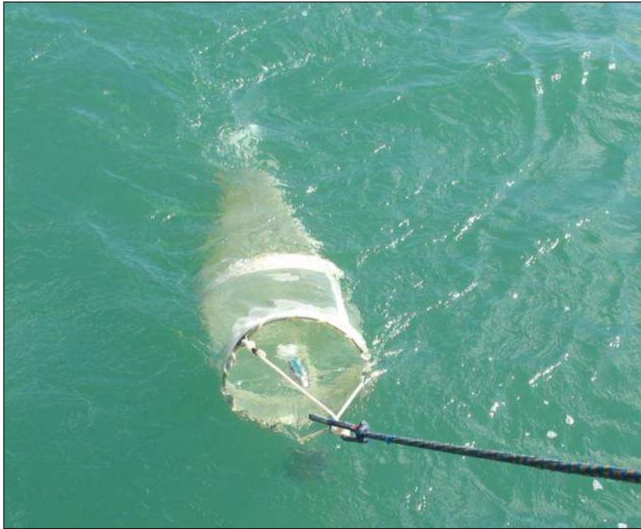
Figura 312. Rede de plâncton com malha de 220 \mu m de abertura.
