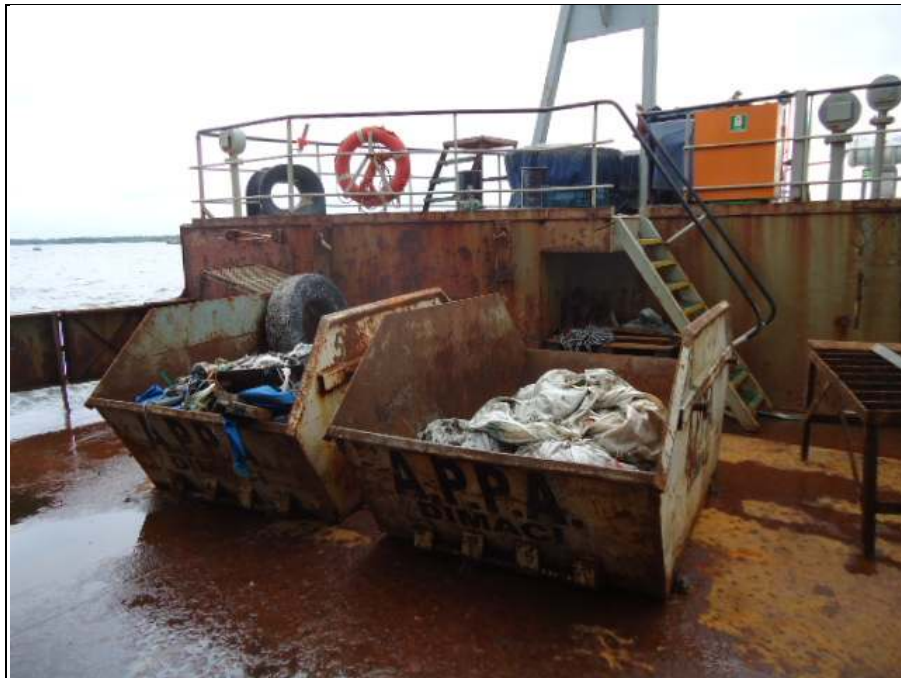
Figura 66. Armazenamento dos resíduos, oriundos da dragagem, retidos pelo sistema de contenção.
