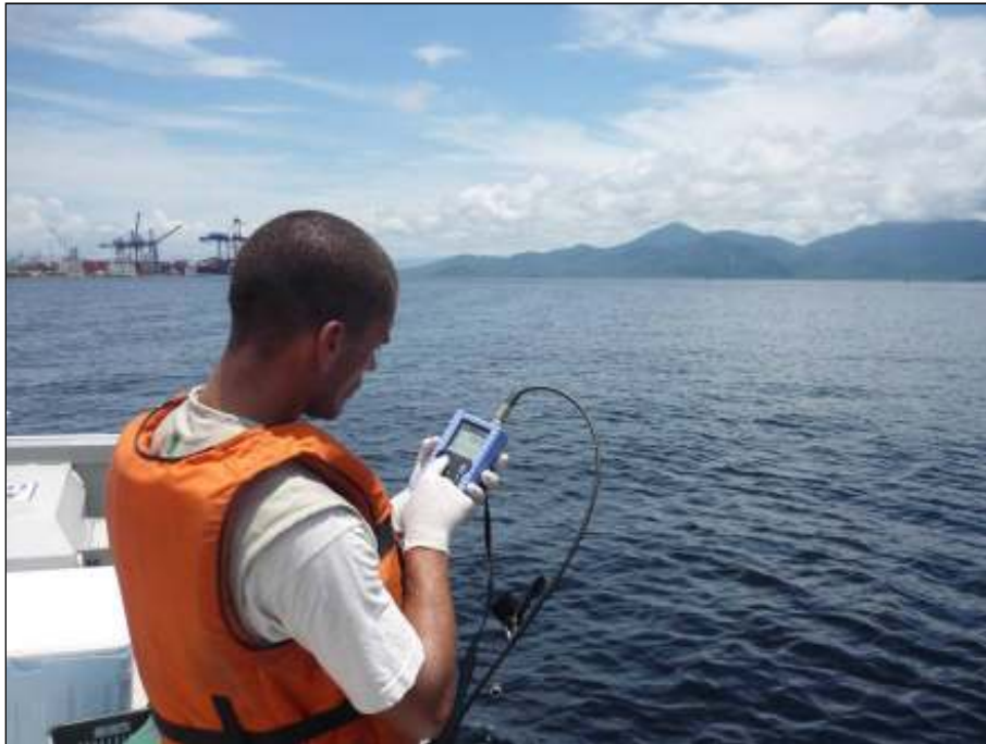
Figura 80. Sonda multiparâmetro utilizada na mensuração de parâmetros in situ .
