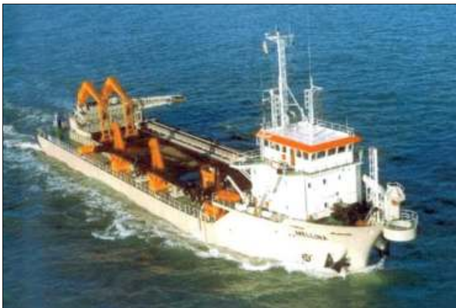
Figura 62. Exemplo de draga autotransportadora com capacidade de armazenamento em cisterna de 5.000m 3 .
