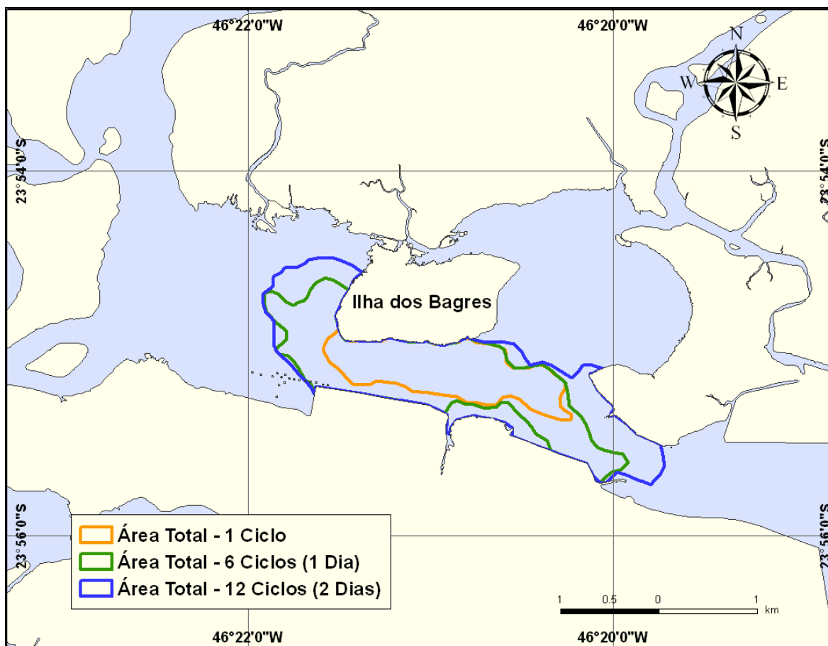
Figura IV-40 - Área de influência das plumas de sedimentos ressuspensos durante as operações de dragagem na Seção 2, no período de verão.
