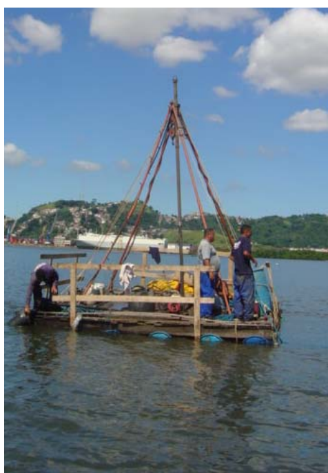
Foto 9.3.9.2-6: Flutuante utilizado na coleta das amostras de subsuperfície executadas pela equipe da Túzzolo Engenharia, com supervisão da ASA South America
