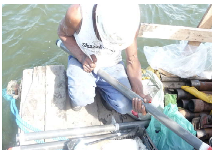
Foto 9.3.9.2-9: Retirada e identificação das amostras de subsuperfície pela equipe da Túzzolo Engenharia
