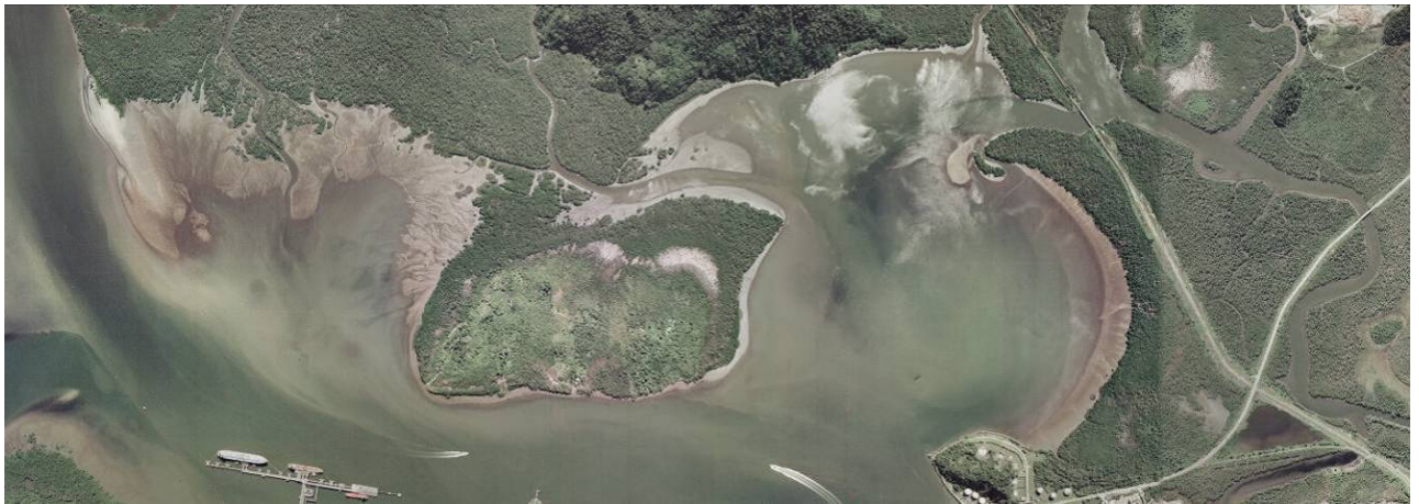
Foto 9.3.4.3-1: Fotos aéreas recentes. Da esquerda para a direita, região do Canal de Piaçaguera, Largo do Caneú, Ilha dos Bagres, Largo de Santa Rita/Foz do Rio Jurubatuba, e extremidade da Ilha de Barnabé. Deposição de sedimentos finos recentes na região dos largos do Caneú e de Santa Rita, propiciando o assoreamento deste locais e permitindo a integração de porções de terras isoladas com o continente. Porção continental do Município de Santos.
