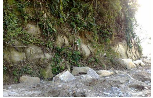
Foto 9.3.4.5-6: Exposição da unidade ortognáissica (NPccog). Corte recente efetuado no início da estrada de acesso ao Sítio Santa Rita, em área do Aterro Terrestre Ambiental. O gnaiss apresenta-se fortemente orientado com foliação gnáissica regional NE-SW e mergulho ao redor de 70° SE, indicando estruturação segundo a Zona de Cisalhamento Freires - São Lourenço. Também ocorrem fraturas ortogonais associadas. Porção continental do Município de Santos.
