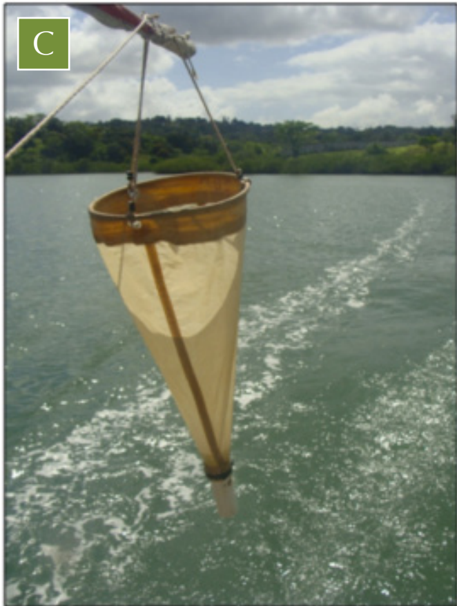
Fotos de organismos planctônicos (A e B) e equipamento para coleta (rede cônica para plâncton) (C).
