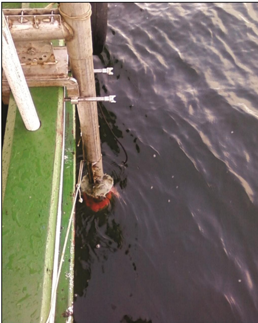
Figura 5.1.10.10: Detalhe da EcoSSonda ADCP e sua adaptação na lateral do barco
