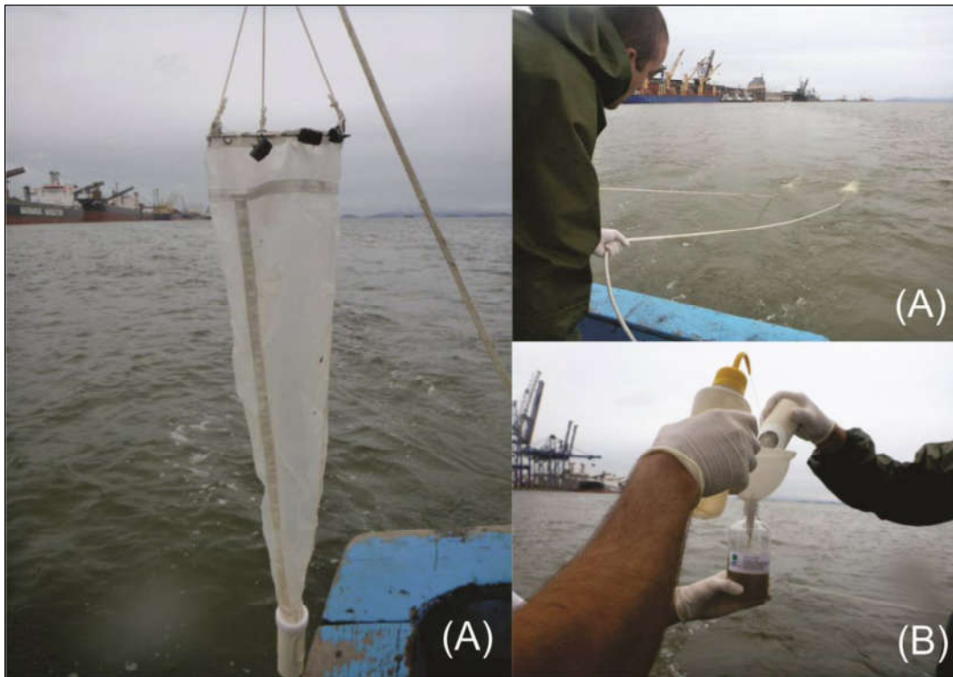
Figura 8.2.40 - Rede utilizada para coleta de amostra da comunidade Zooplancônica (A), e acondicionamento da amostra (B).
