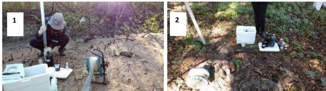
**Figura 8.69 – Coleta de amostra sendo realizada no PM-01 (1) e frascaria utilizada no acondicionamento das amostras de água coletadas nos poços de monitoramento (2).**
