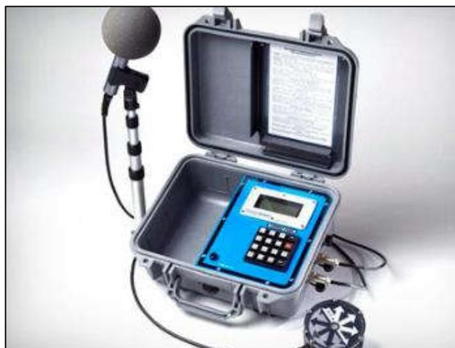
**Figura 8.13 – Sismógrafo com geofone e microfone.**
