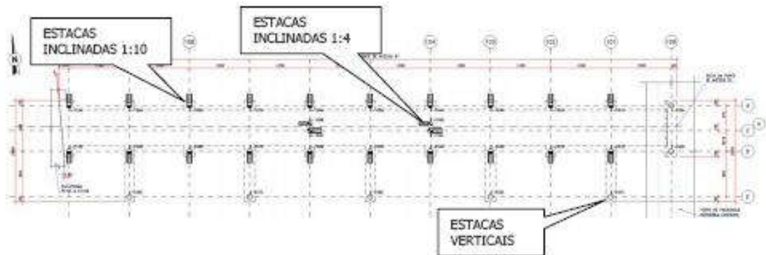
Figura 5.33 – Ponte de Acesso 1 – Estaqueamento
