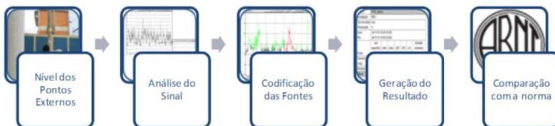
**FIGURA 5.1.4-2 – Representação do processo de medição de ruído ambiental e análise.**
