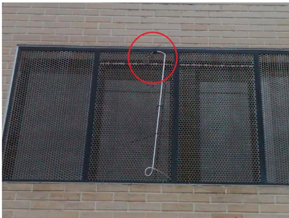
FIGURA 5.1.5-2 – Ponto de coleta de ar na parte externa do escritório, para monitorar SO<sub>2</sub> e NO<sub>x</sub>.
