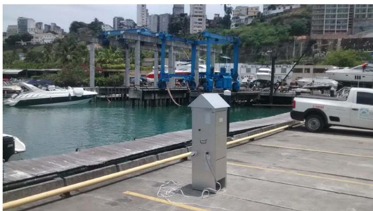
**FIGURA 5.1.5-3 - Hi-Vol instalado no Ponto 01 (quebra mar).**
