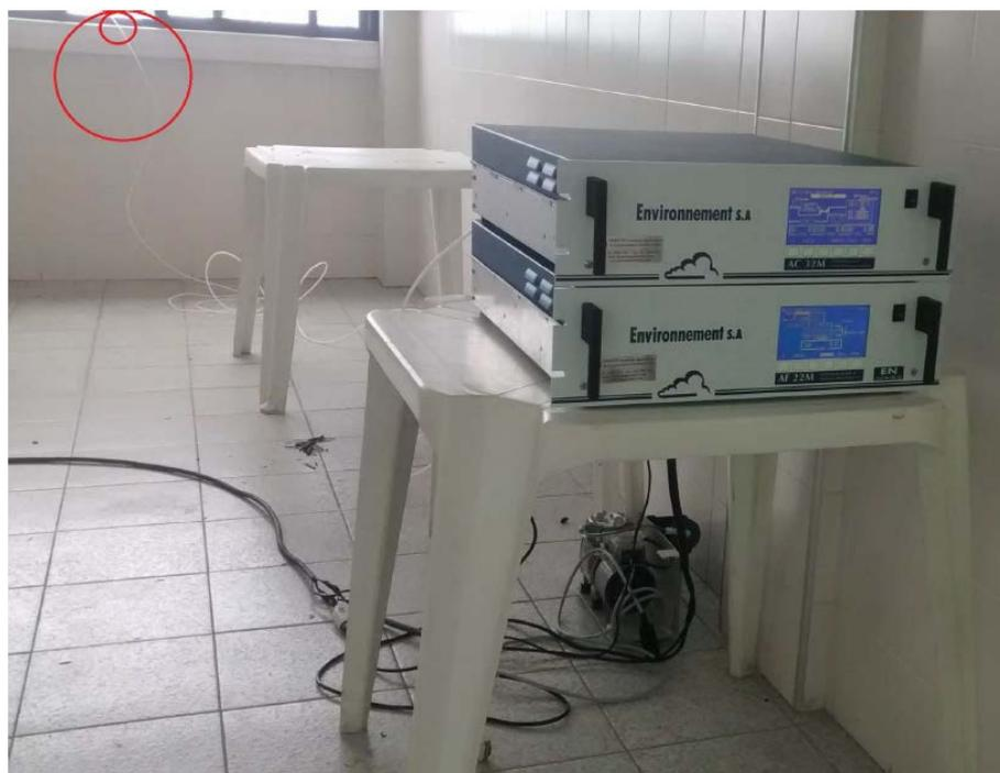
FIGURA 5.1.5-1 – Monitores contínuos de SO<sub>2</sub> e NO<sub>x</sub>.
