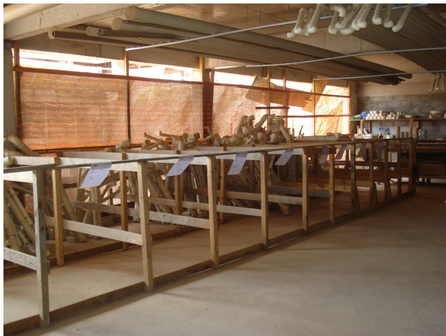
FIGURA 2.3-31 – Central de produção de kit's: baias para estoque dos kit's fabricados com identificação dos locais onde serão instalados.
