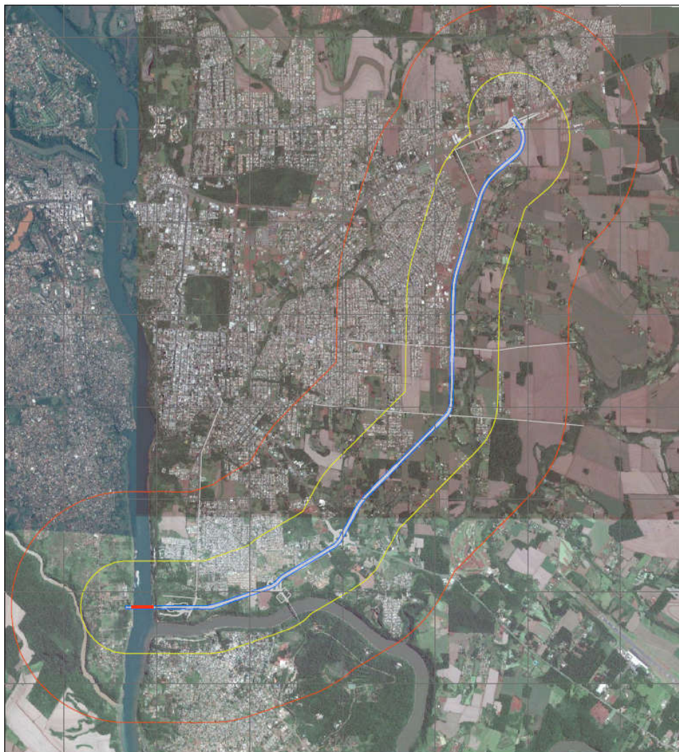
Figura 24. Localização do empreendimento. Em amarelo Área de Influência Direta e em laranja Área de Influência Indireta. Em vermelho, local onde será implantada a ponte sobre o rio Paraná. Na cor roxa o acesso à ponte com 14,7 km de extensão.
