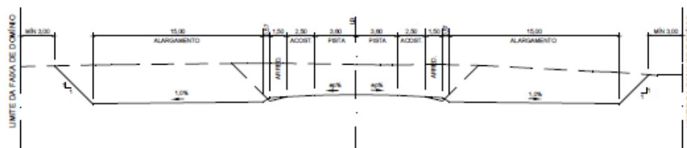
Figura 16. Pista Simples com alargamento. Fonte: VETEC, 2013.
