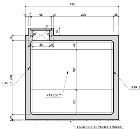
**DETALHE DAS PLACAS PRÉ-MOLDADAS (3x)**
