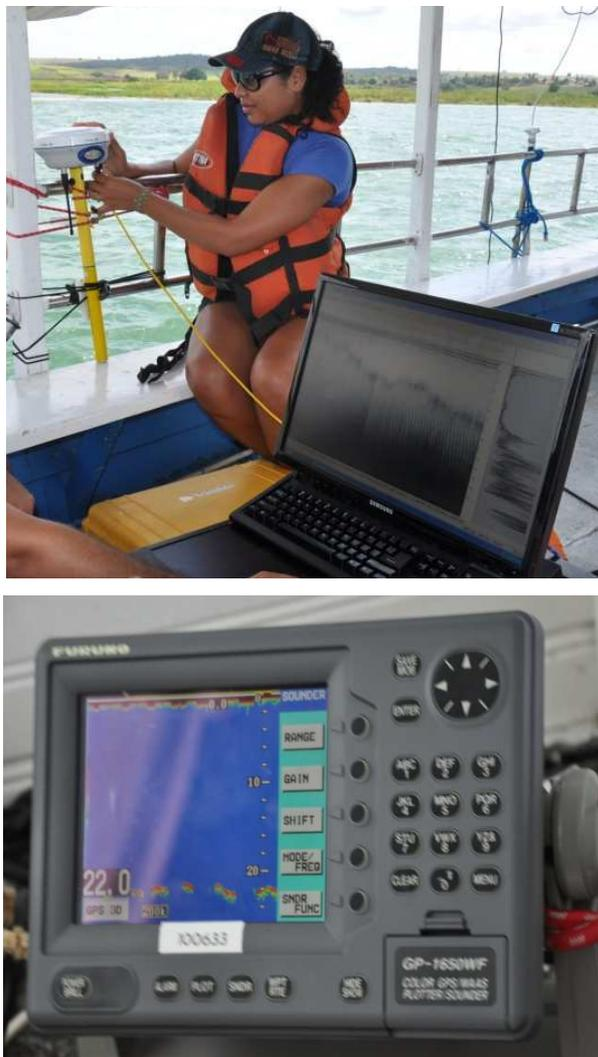
**Figura II.7.** Antena receptora do GPS geodésico e tela da ecossonda FURUNO.
