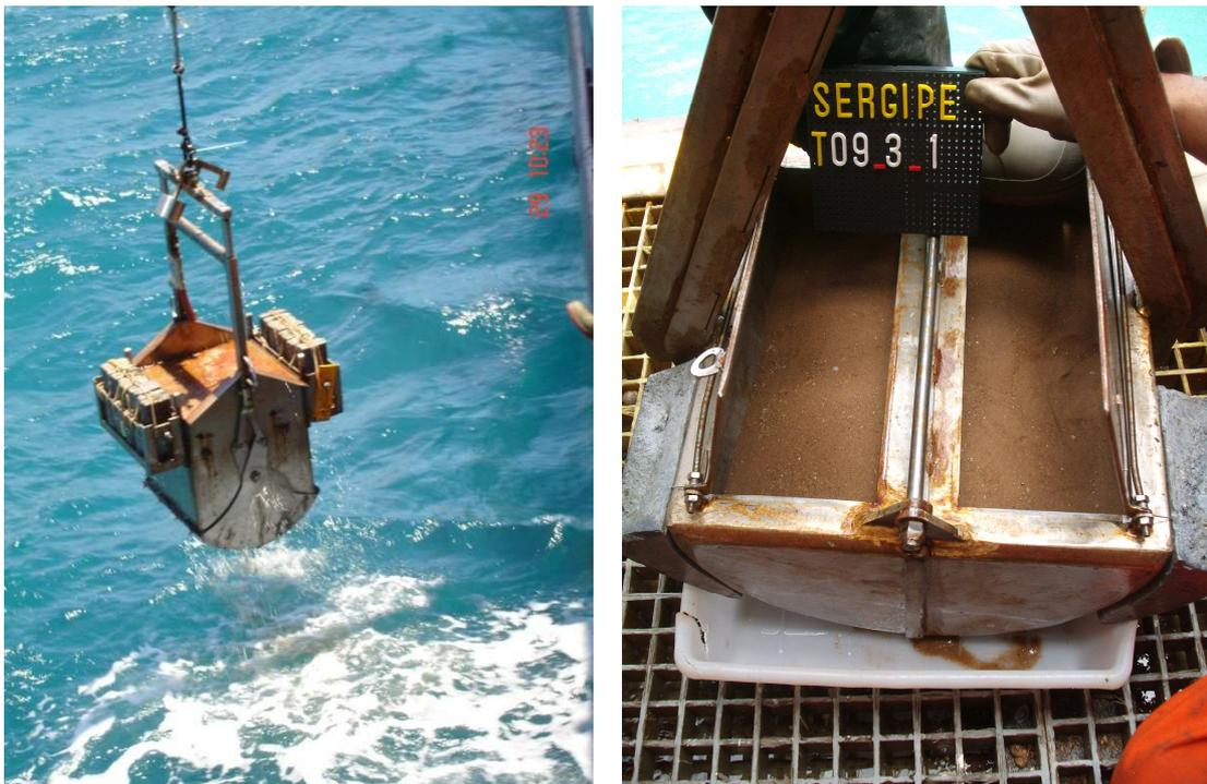
**Figura II.3.** Amostradores de sedimentos: a) Box Core (esquerda) e b) Van Veen (direita).
