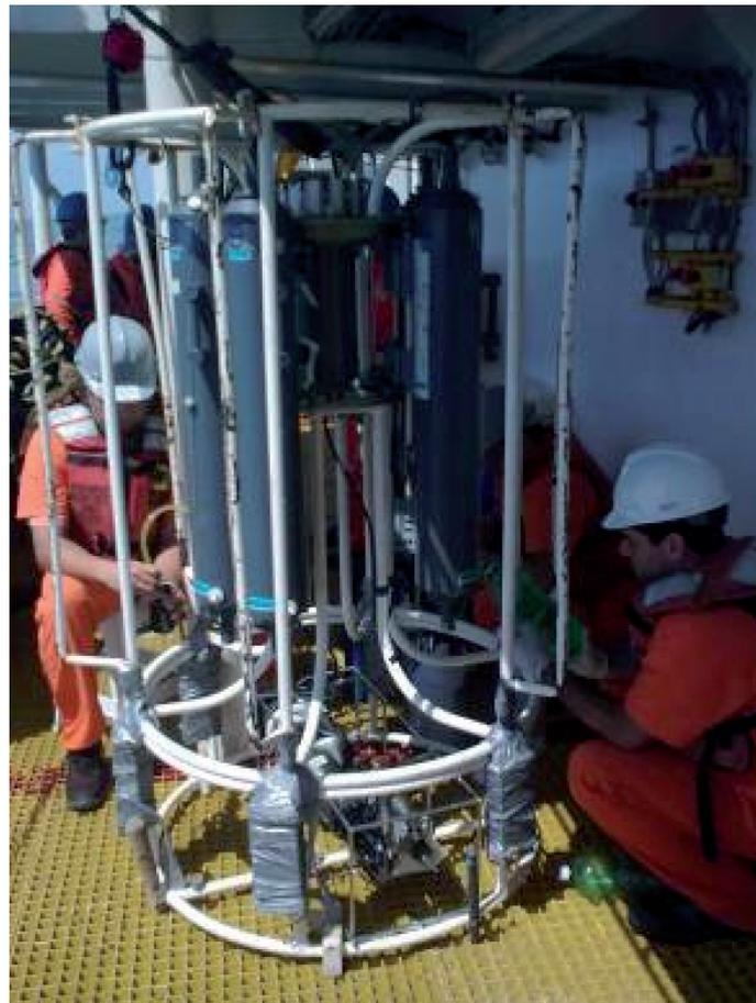
**Figura 2 - Rosette com garrafas Niskin e GO-FLO utilizada para coleta das amostras.**
