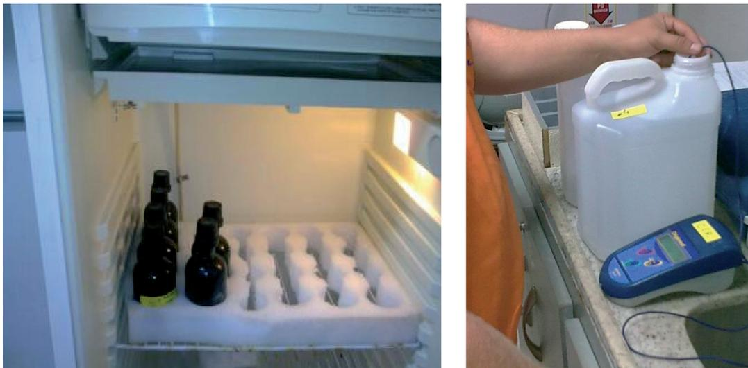
**Figura 3 - Implementação do experimento de DBO**
