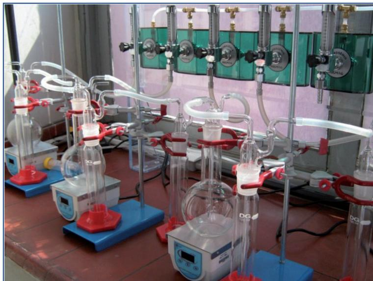
**Figura 5** - Detalhe do sistema montado para extração ácida dos sulfetos voláteis em amostras de sedimento.
