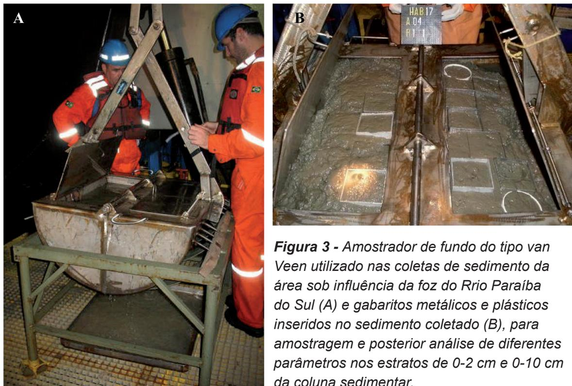
**Figura 3** - Amostrador de fundo do tipo van Veen utilizado nas coletas de sedimento da área sob influência da foz do Rio Paraíba do Sul (A) e gabaritos metálicos e plásticos inseridos no sedimento coletado (B), para amostragem e posterior análise de diferentes parâmetros nos estratos de 0-2 cm e 0-10 cm da coluna sedimentar.
