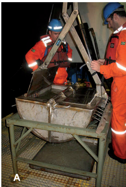
Figura 3 - Amostrador de fundo do tipo van Veen utilizado nas coletas sobre a Plataforma Continental (A) e gabaritos metálicos e plásticos inseridos no sedimento coletado com este equipamento (B).
