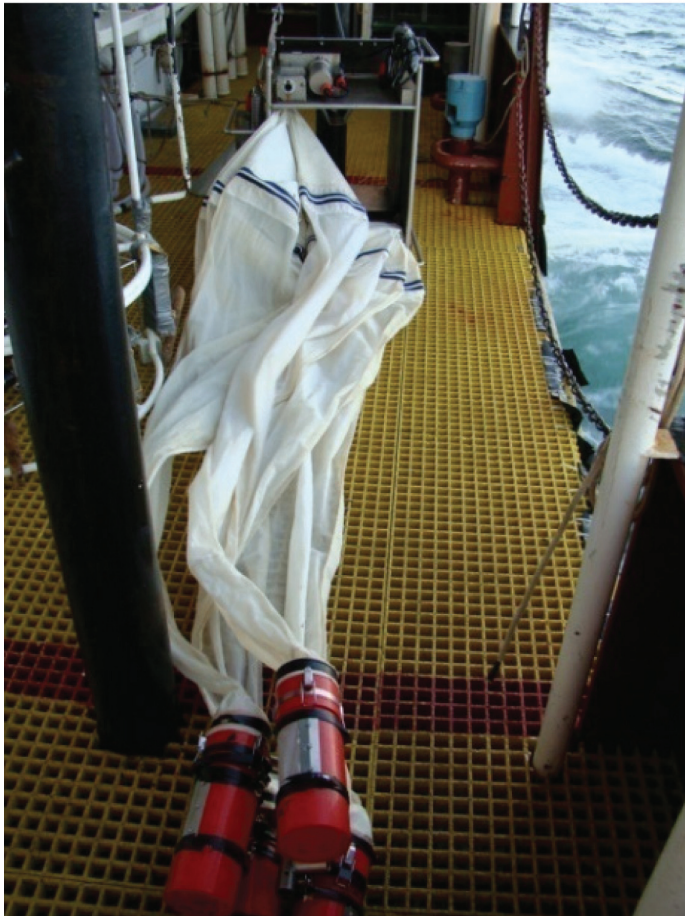
Figura 6 - Rede de plâncton do tipo MULTINET equipada com sistema de fechamento remoto.
