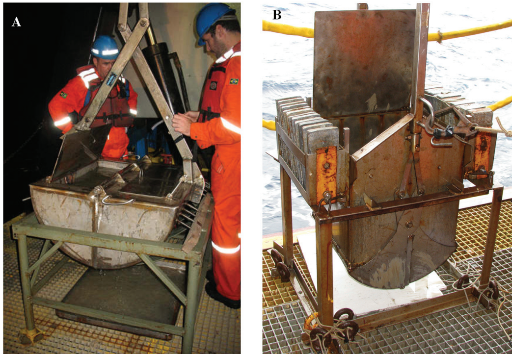
Figura 8 – Amostrador de fundo do tipo vanVeen utilizado nas coletas de sedimento da Plataforma Continental e foz do Rio Paraíba do Sul (A). Box-corer utilizado nas coletas de sedimento do Talude e Cânions (B).
