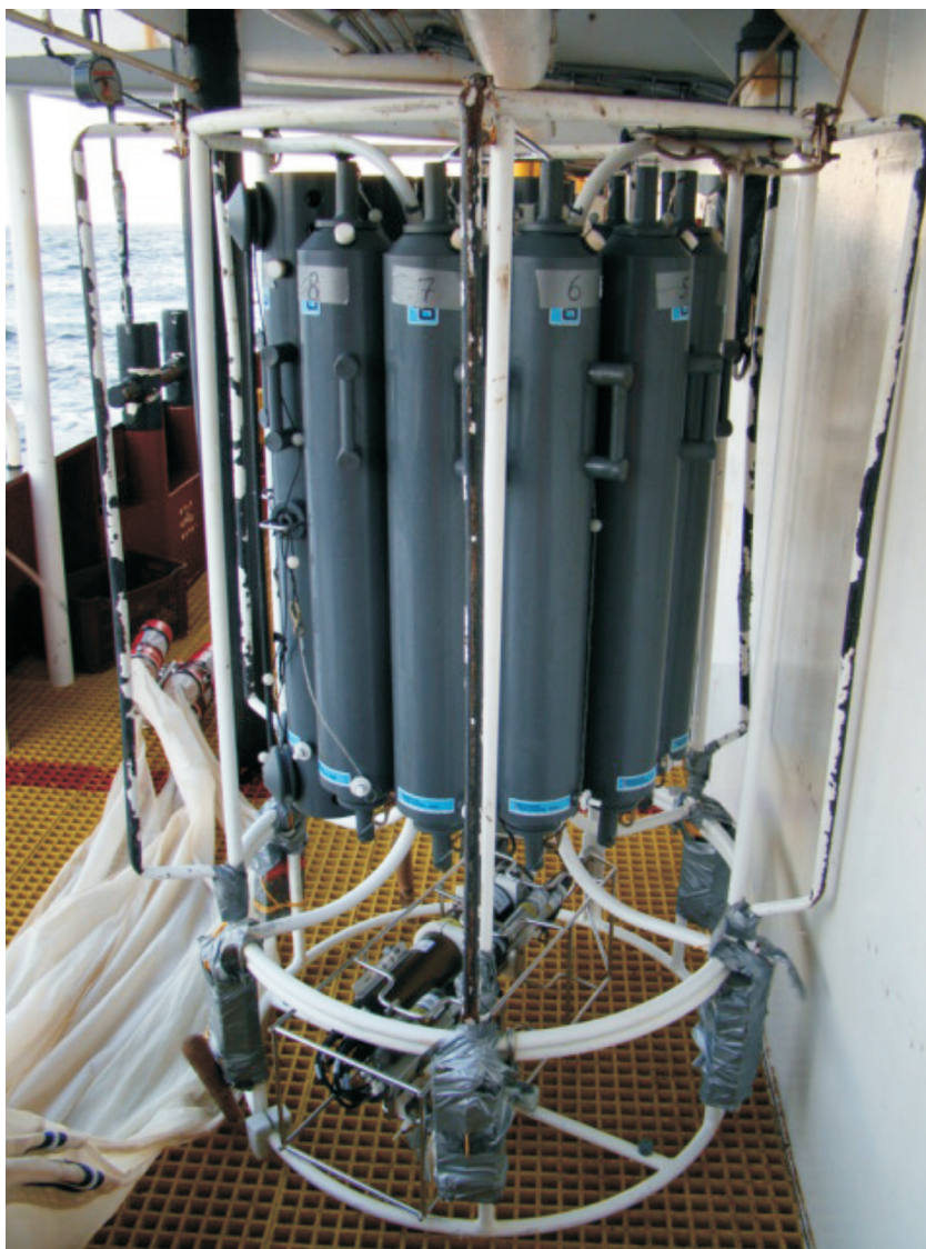
Figura 4 - Rosette equipada com garrafas Niskin, GO-FLO e CTD.
