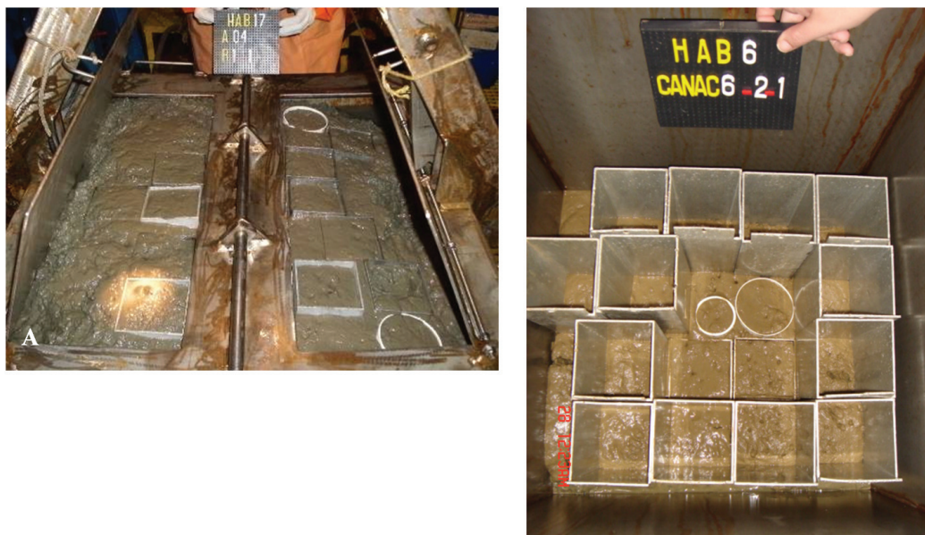
Figura 9 – Gabaritos metálicos e plásticos inseridos no sedimento coletado com vanVeen (A) e Box-corer (B), para amostragem e posterior análise de diferentes parâmetros nos estratos de 0-2 cm e 0-10cm da coluna sedimentar.
