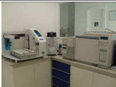
Cromatógrafo em fase gasosa acoplado ao espectrômetro de massas para análise de voláteis
