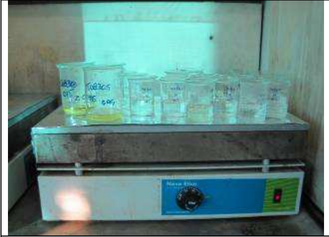
Sistema de digestão de amostras de sedimento para análise de COT e Nitrogênio Total
