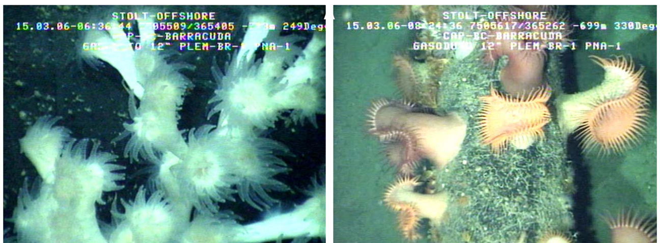
Figura 13. Crescimento de corais pétreos (esquerda) e anêmonas (direita) sobre um duto rígido no campo de Barracuda.
