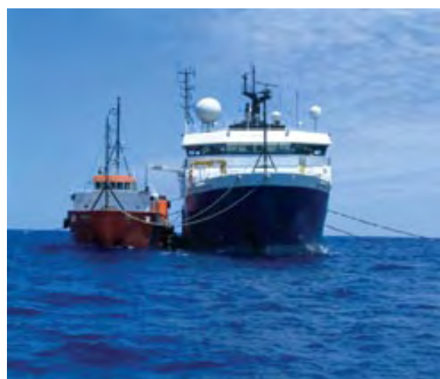
Barco de apoio e navio sísmico, emparelhados em alto-mar, para realizar o processo de abastecimento
