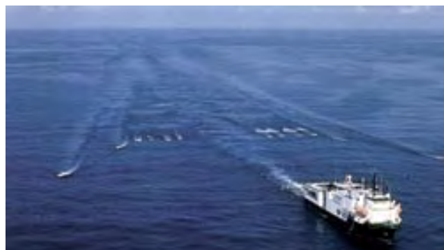
Navio sísmico arrastando os cabos sísmográficos e hidrofones
