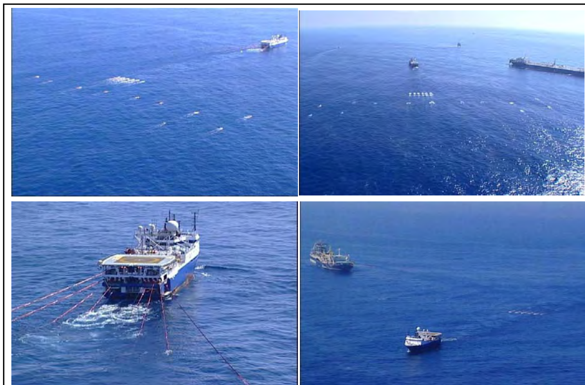
Figura II.2.3-2 - Fotos aéreas ilustrando um arranjo sísmico rebocado durante uma operação de aquisição de dados (Fonte: Petrobras)
