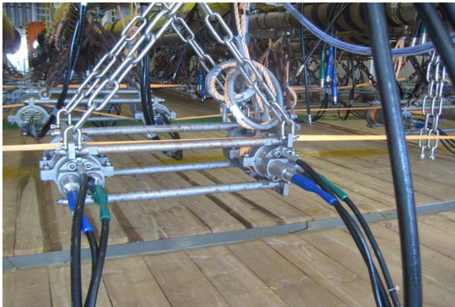
Figura 14 – Canhões de ar dispostos a bordo do navio Ocean Europe.
