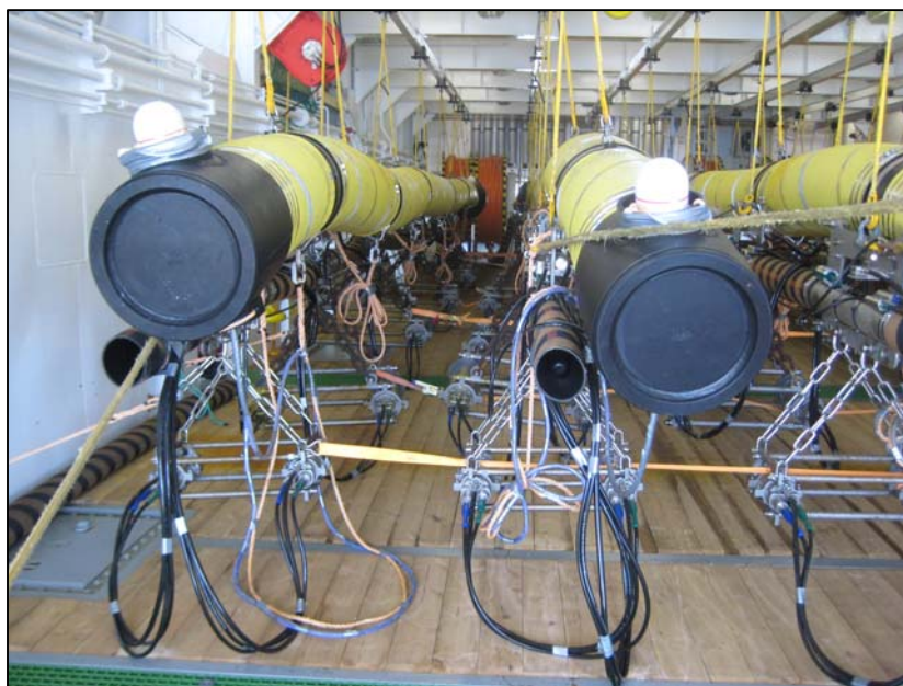
Figura 15 - Bóias do Sistema de flutuação dos Canhões de Ar (AirGuns) armazenados no convés do navio fonte.
