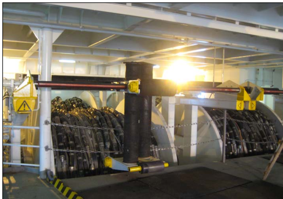
Figura 12 – Cabo de fundo armazenado nos carretéis dos guinchos do navio.
