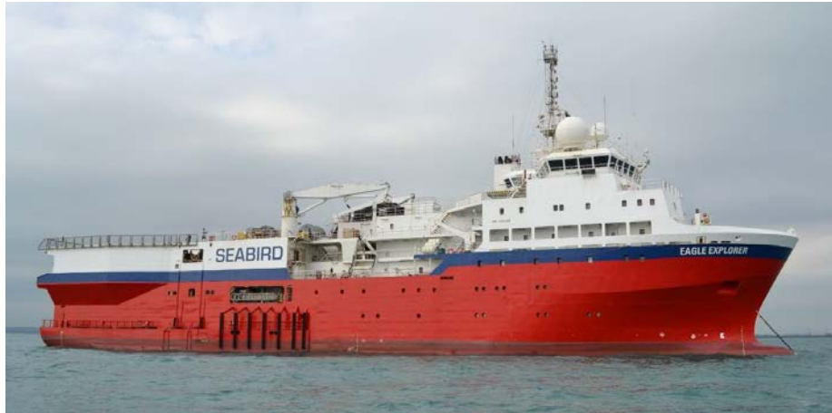
Figura II.1-5 – Embarcação Sísmica Eagle Explorer.
