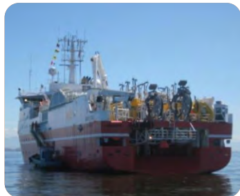
Figura 8 – Sistema de guinchos e polias do navio de lançamento de cabos.
