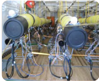
Figura 12 – Boias do Sistema de flutuação das fontes sonoras armazenadas no convés do navio fonte.
