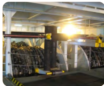
Figura 9 - Cabo de fundo armazenado nos carretéis dos guinchos do navio.
