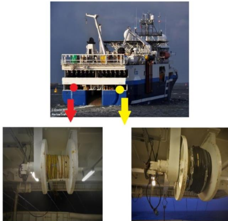
Figura II.2.3-3: Fotografias indicando os dois pontos de lançamento do cabo MAP na embarcação Oceanic Champion. Os ícones em amarelo indicam o posicionamento do ponto de lançamento de boreste e os ícones em vermelho indicam o ponto de lançamento de bombordo, ambos no gun deck .
