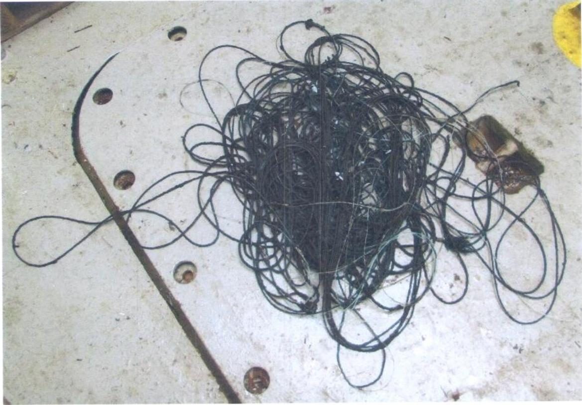
Figura 2. Petrecho de pesca retirado do cabo sísmico.
