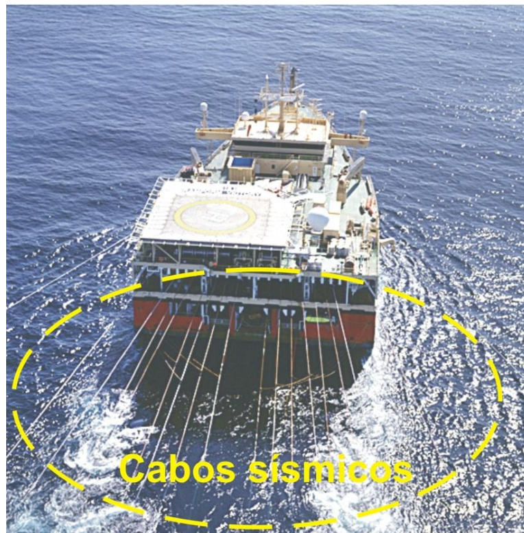
Figura 2e - Imagem da popa do navio sísmico mostrando os cabos sísmicos.
