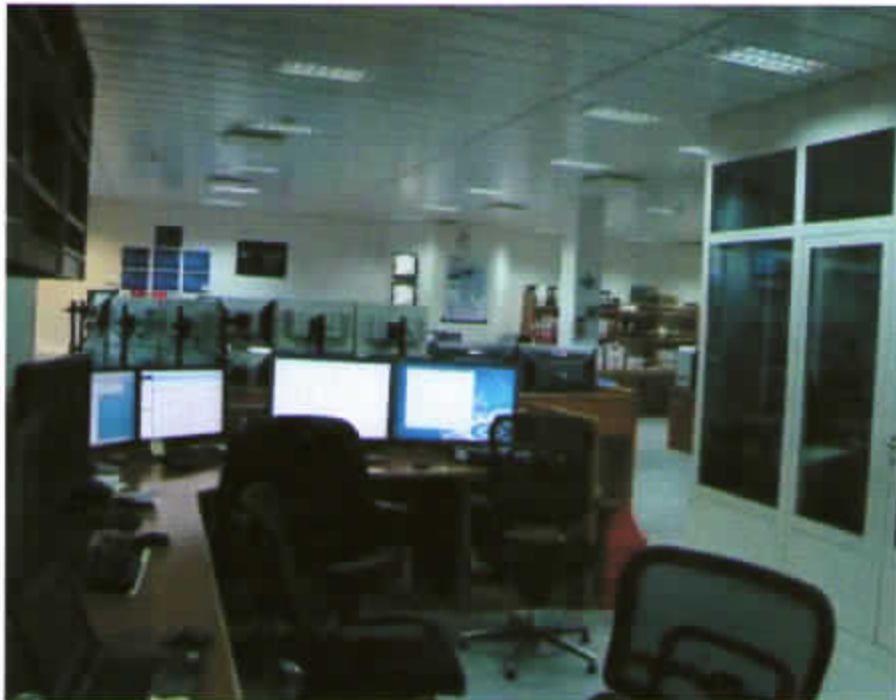
Foto #2 – Monitores utilizados no controle do posicionamento do barco de trabalho na Sala de Instrumentos
