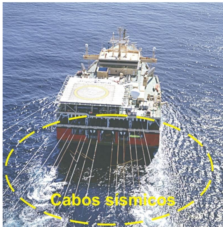
Figura 2.2h - Imagem da popa do navio sísmico mostrando os cabos sísmicos.
