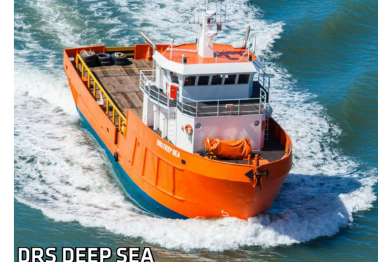
DRS DEEP SEA - 31,8 metros de comprimento; - 7,9 metros de boca; - casco laranja e superestrutura branca.
