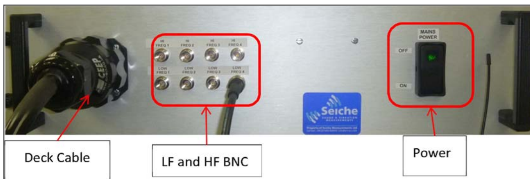
Figura 3.3.5.3e - Caixa de Buffer (painel frontal).
