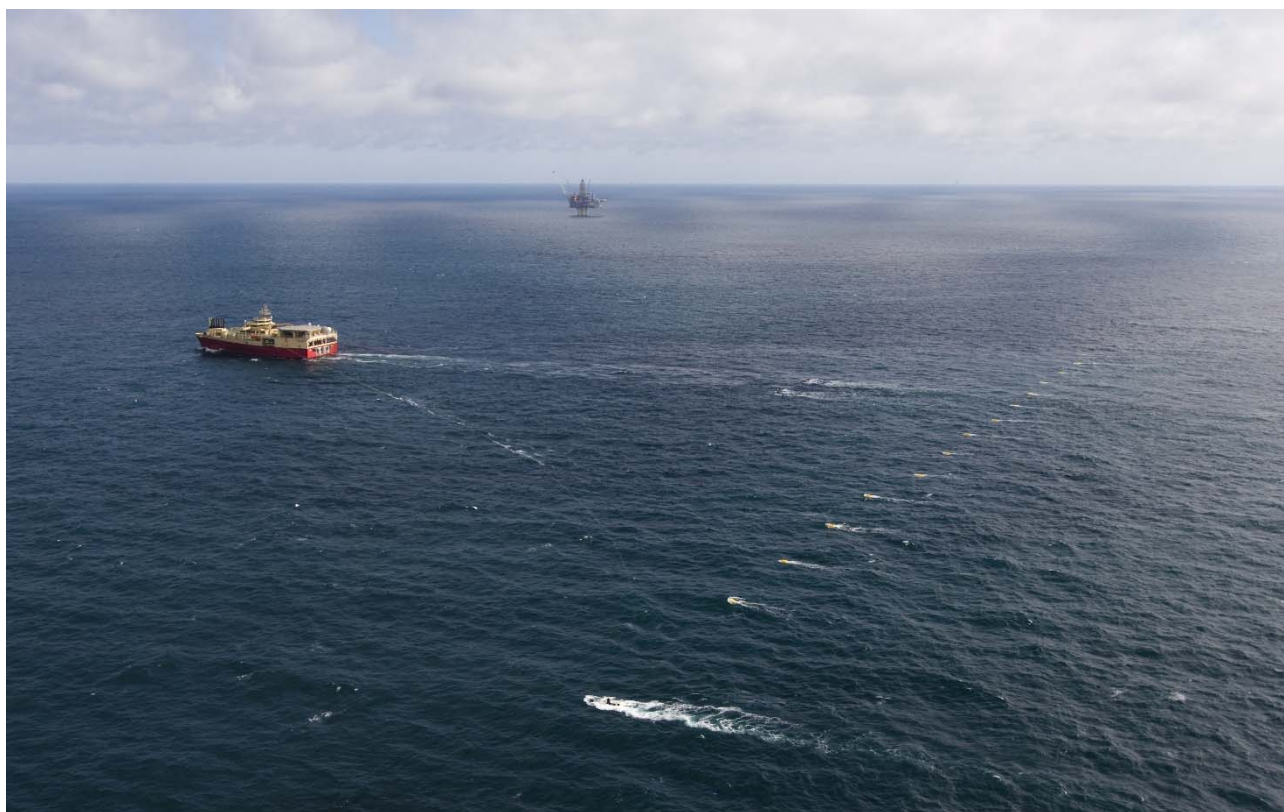
Figura 1.6a - Imagem aérea do navio sísmico mostrando a distribuição dos flutuadores da fonte sísmica e das boias do início dos cabos sísmicos.
