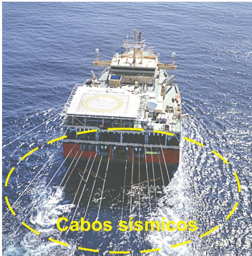
Figura 2.1f - Imagem da popa do navio sísmico mostrando os cabos sísmicos.
