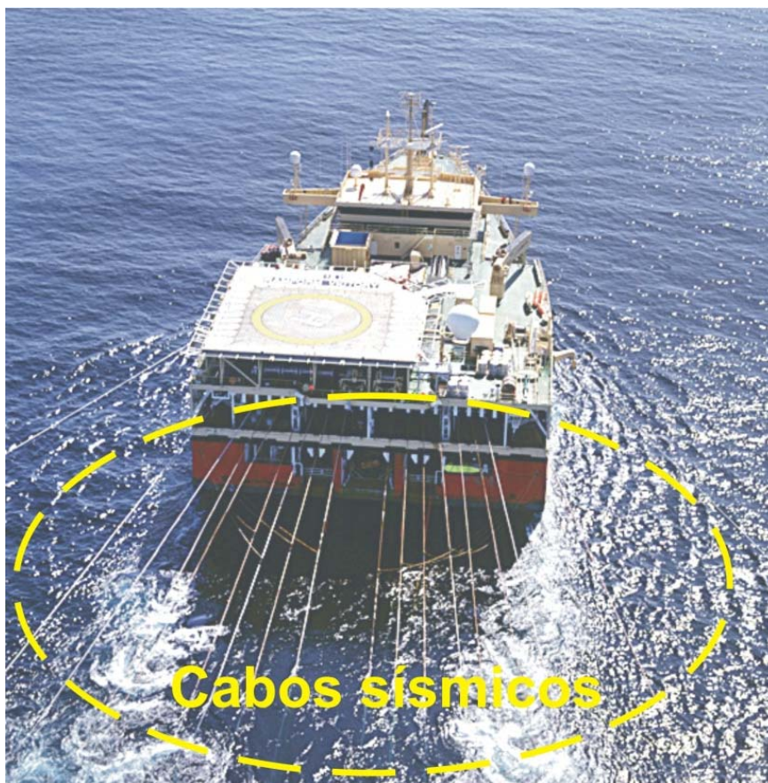
Figura 2.2c - Imagem da popa do navio sísmico mostrando os cabos sísmicos.
