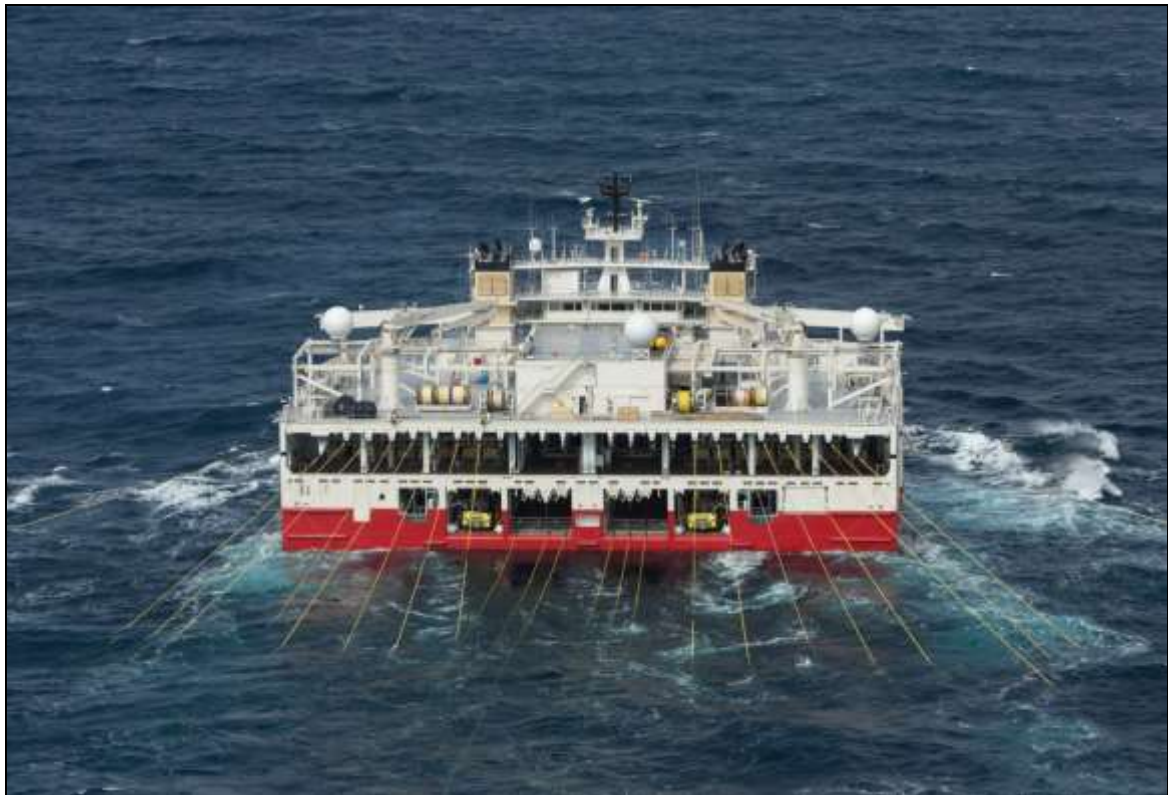
Figura II.2-3 - Cabos sísmicos conectados à popa da embarcação sísmica.
