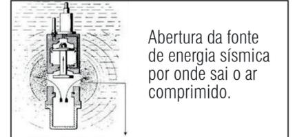
Abertura da fonte de energia sísmica por onde sai o ar comprimido.
