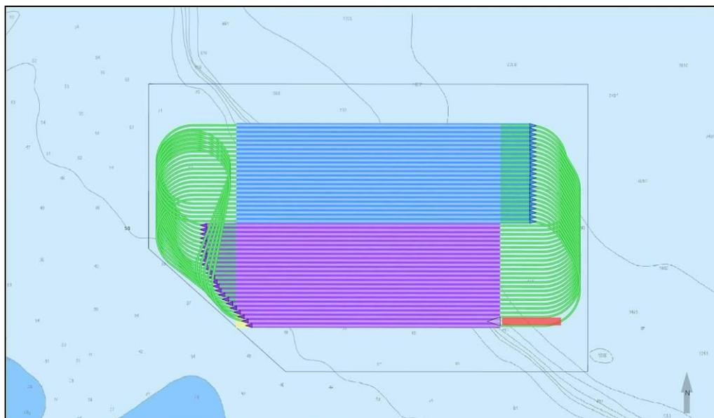
Figura 1-11 – Esquema da manobra do navio sísmico a ser realizada na área de atividade.
