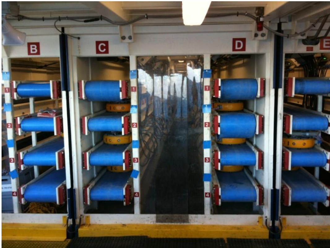
Figura II.3.4.1-4 - Estantes e esteiras rolantes para armazenamento dos nódulos Z700 (Navio Cory Chouest).
