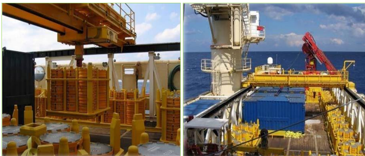
Figura II.3.4.1-9 - Convés automatizado da embarcação de apoio/installação Carolyn Chouest e os nódulos contidos nas gaiolas.
