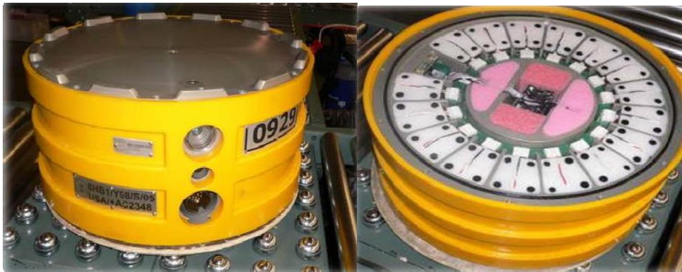
Figura II.3.4.1-7 - Nódulos Z3000, a serem utilizados em profundidades ente 700 e 3000m.
