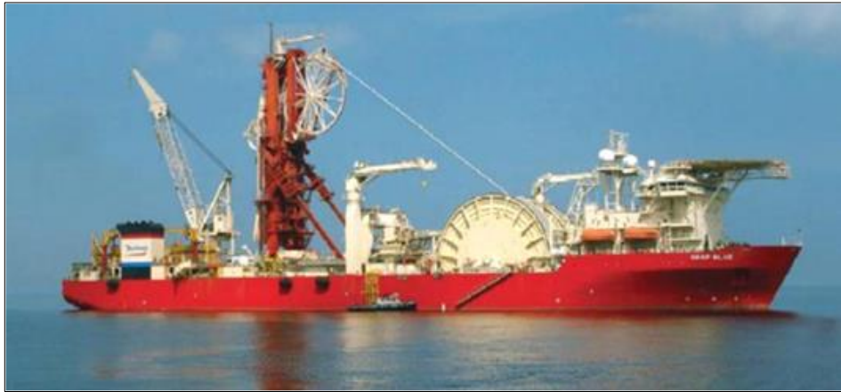
Figura II.2.4.6.4-5 – Exemplo de embarcação Método Reel-Lay.
