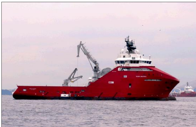
Figura II.2.4.5.1.10-3 – Exemplo de navio AHTS (Anchor Handling Tug Supply) que poderá ser utilizado na instalação da ancoragem dos FPSOs.
