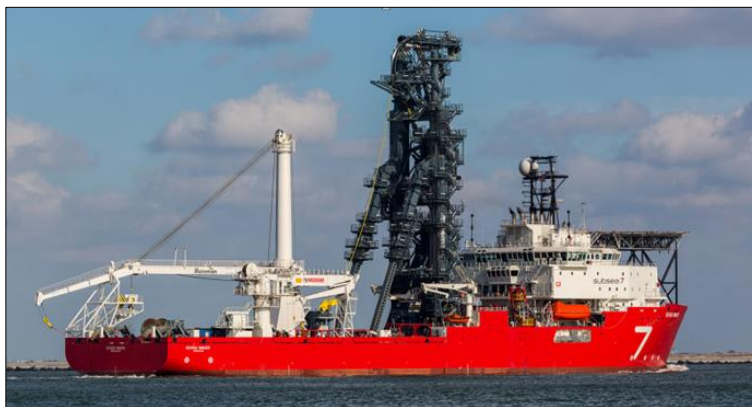
Figura II.2.4.5.1.10-1 – Exemplo de Navio Lançador de Linha - PLSV (Pipe Laying Support Vessel).
