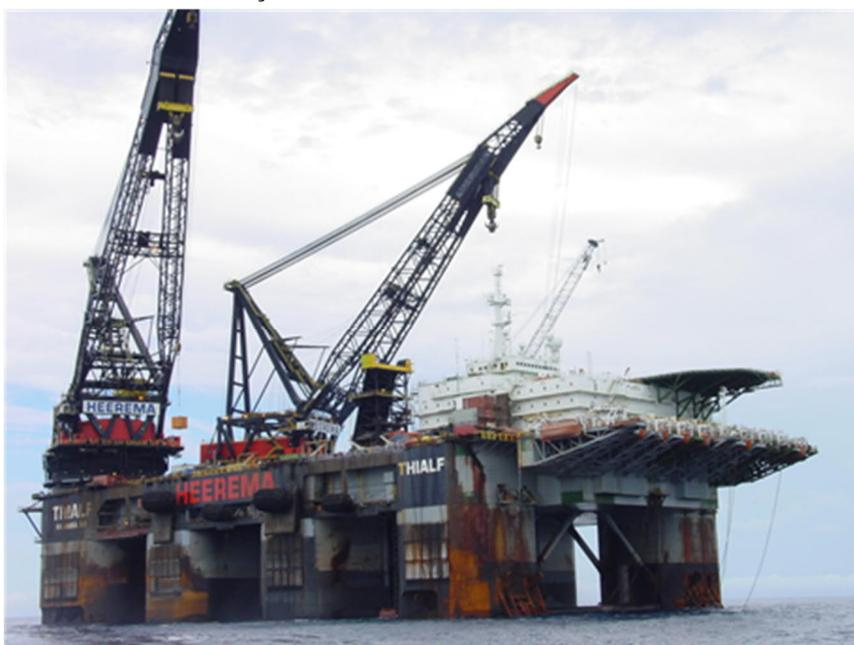
**FIGURA 4 - Navio de elevação pesada SSCV Thialf a ser utilizado nas atividades de instalação do projeto Peregrino Fase II.**
