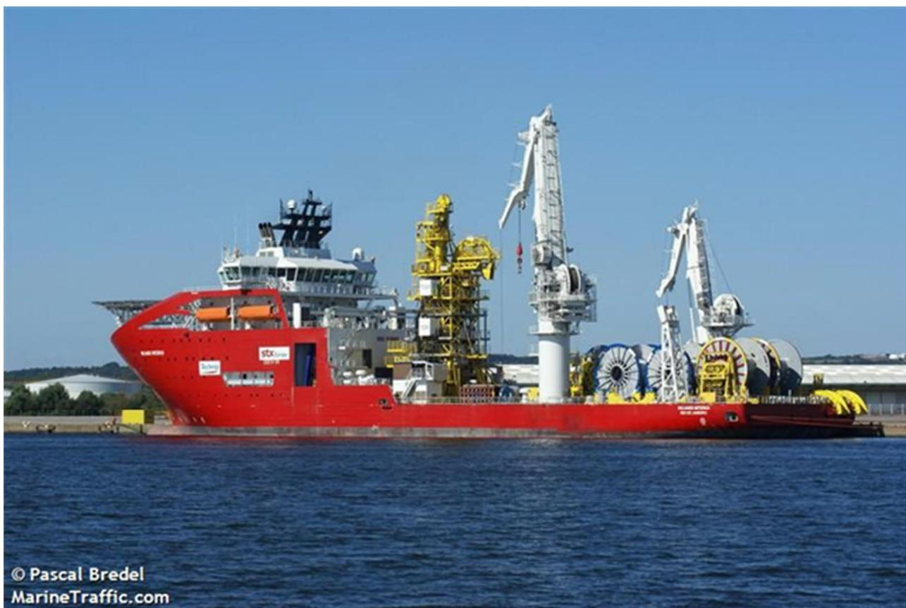
**Figura 11 - Embarcação Skandi Niterói (Figura 11) será utilizada nas atividades de instalação do projeto Peregrino Fase II**
