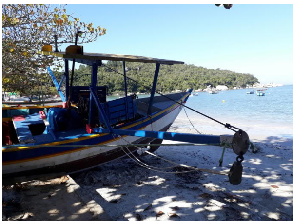
Foto 16 – Embarcação equipada com tangones para arrasto duplo do camarão de Armação da Fazenda, Governador Celso Ramos.
