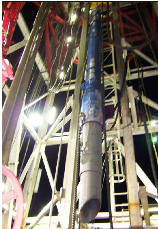
**FIGURA II.2.49 – Martelo hidráulico com condutor devidamente posicionado na unidade de perfuração.**
