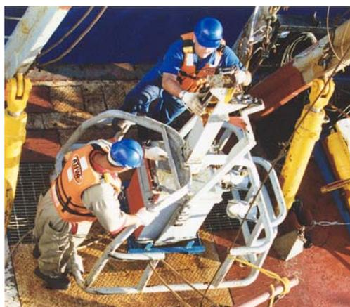
*Box-corer utilizado para a coleta de sedimentos em estudos de monitoramento.*
