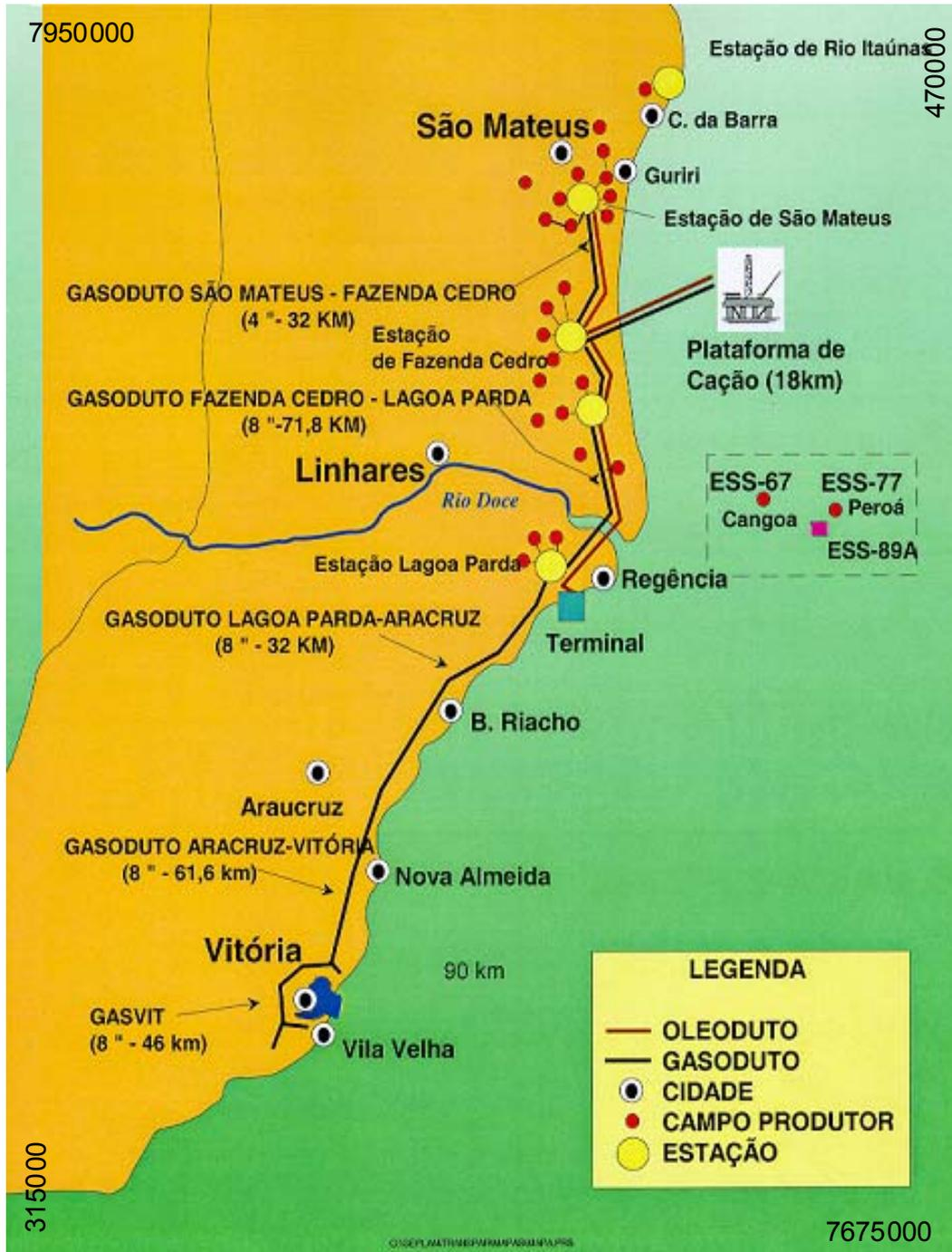
Figura ilustrativa da área dos campos de Peroá e Cangoá (com os cinco poços). (Coordenadas UTM, Datum Aratu, Meridiano Central 39°).
