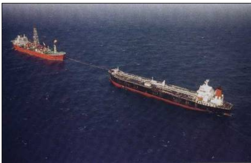
Figura II.8.1.1-9 - Vista aérea da operação de offloading de um FPSO para um navio aliviador
