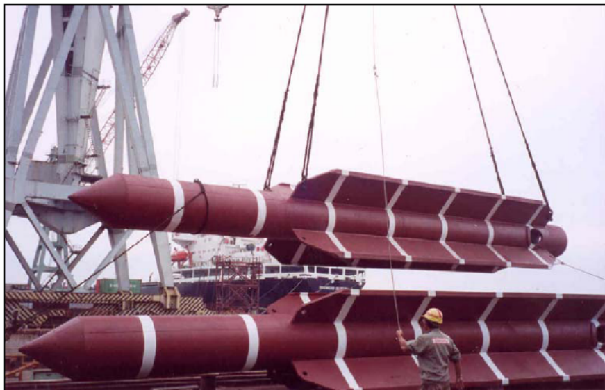
Figura II.2.4-14 - Estaca do tipo torpedo a ser utilizada na ancoragem do FPSO Cidade de São Mateus.
