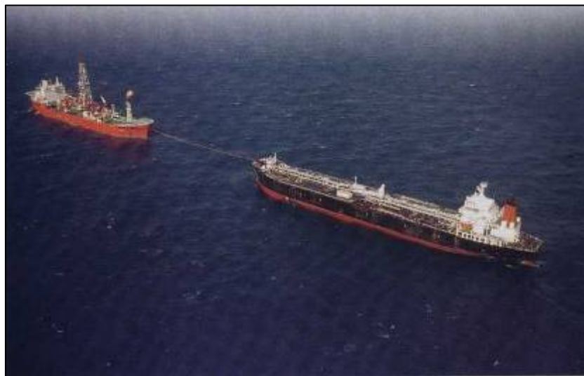
Figura II.2.4-10 - Vista aérea da operação de offloading de um FPSO para um navio aliviador
