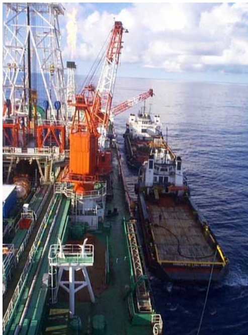
Figura II.2.4-23 - Ilustração de um barco de apoio junto a um FPSO.
