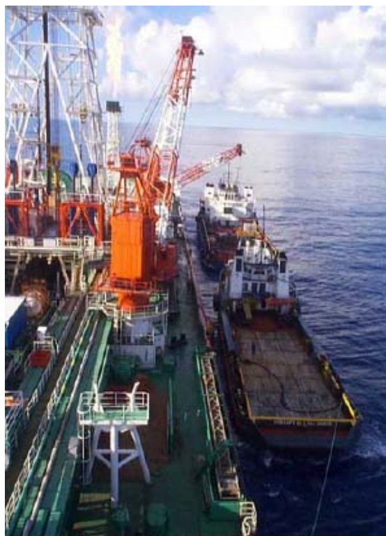
Figura 2.7 - Ilustração de um barco de apoio junto a um FPSO.
