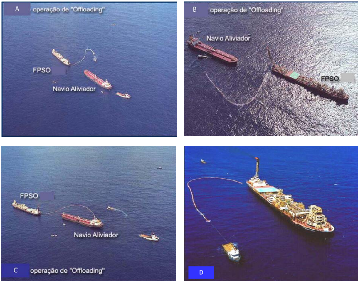
Figura 2.2 Esquema típico mostrando o processo de transferência de petróleo entre uma unidade FPSO e um navio aliviador. A) Barco de apoio estende o mangote de transferência do FPSO até o aliviador; B) Barco de apoio levando o mangote de transferência para o navio aliviador; C) Operação de transferência (offloading) acompanhada por barcos de apoio; D) Barco de apoio retorna com mangote de transferência para o FPSO.
