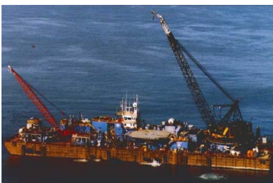
Figura 2.4 - Embarcação "Iroquois", que fará o lançamento do gasoduto de 24".
