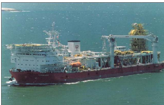
Figura 2.6 - Embarcação de lançamento de linhas de produção.
