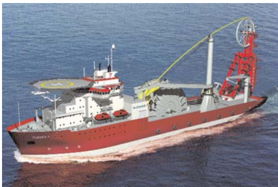
Figura 2.3 - Embarcação "Seven Ocean", que fará o lançamento do gasoduto de 12".
