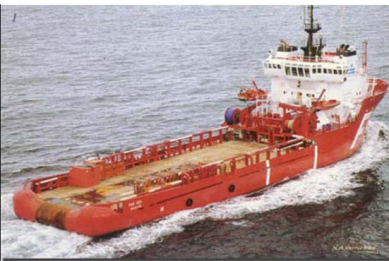
Figura 2.5 - Embarcação para movimentação de âncoras.
