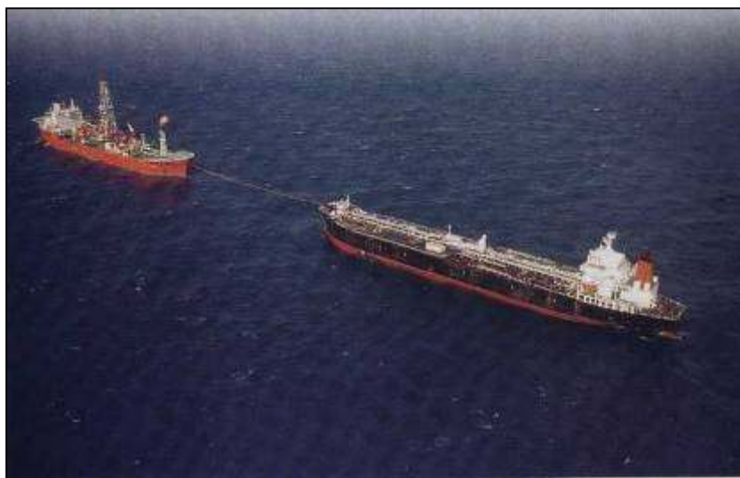
Figura II.2.4-10 - Vista aérea de uma operação de offloading de um FPSO para um navio aliviador.
