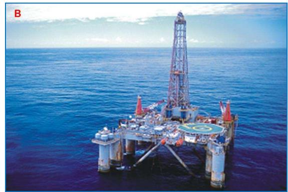
**Figura II.3-3** - (a) Navio-sonda e (b) Semi-submersível.
