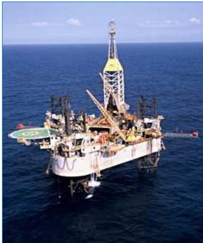
**Figura II.3-5 - Ilustração de uma plataforma auto-elevável.**
